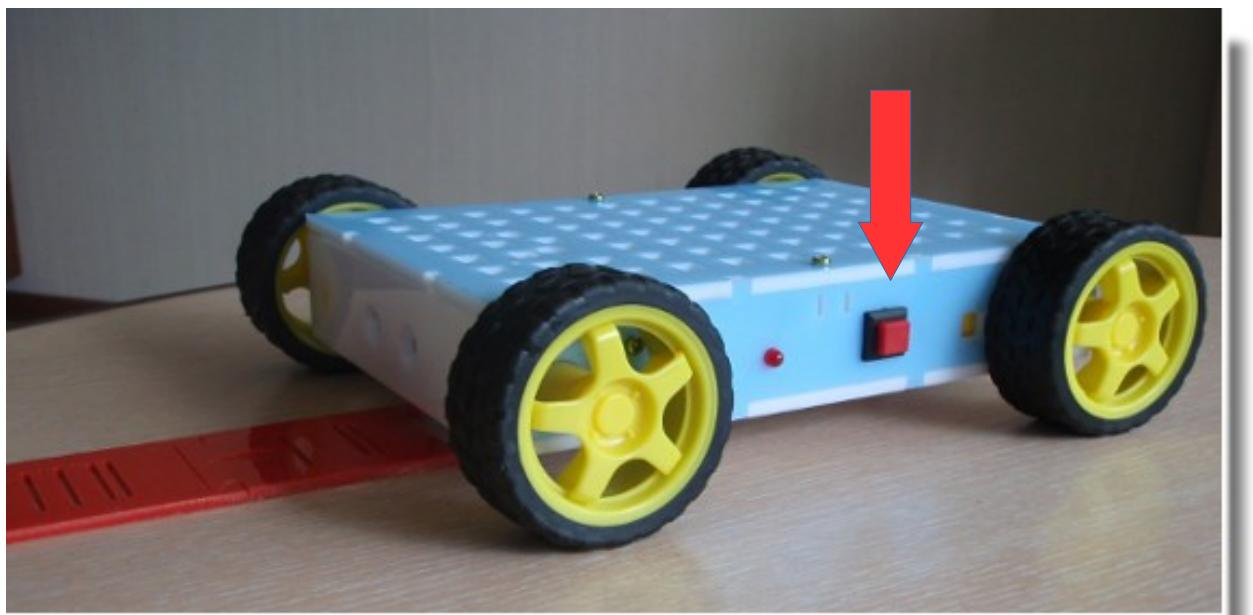
5. Команды считаны, теперь возможна работа в автоматическом режиме: для запуска нажимается зеленая кнопка на правом боку платформы – сохраненная в памяти программа запускается на выполнение.
