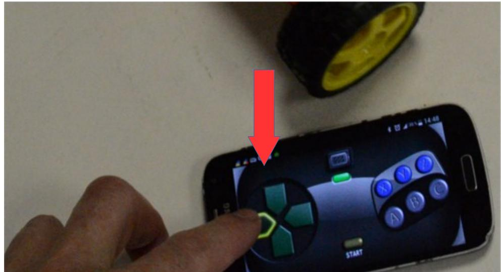
11. Проведя несколько экспериментальных заездов, выровняйте платформу, нажмите на устройстве связи кнопку А (должен прозвучать звуковой сигнал), и попробуйте короткими нажатиями на стрелки добиться, чтобы платформа проехала по квадрату, вновь нажмите на кнопку А (должен прозвучать второй звуковой сигнал)
