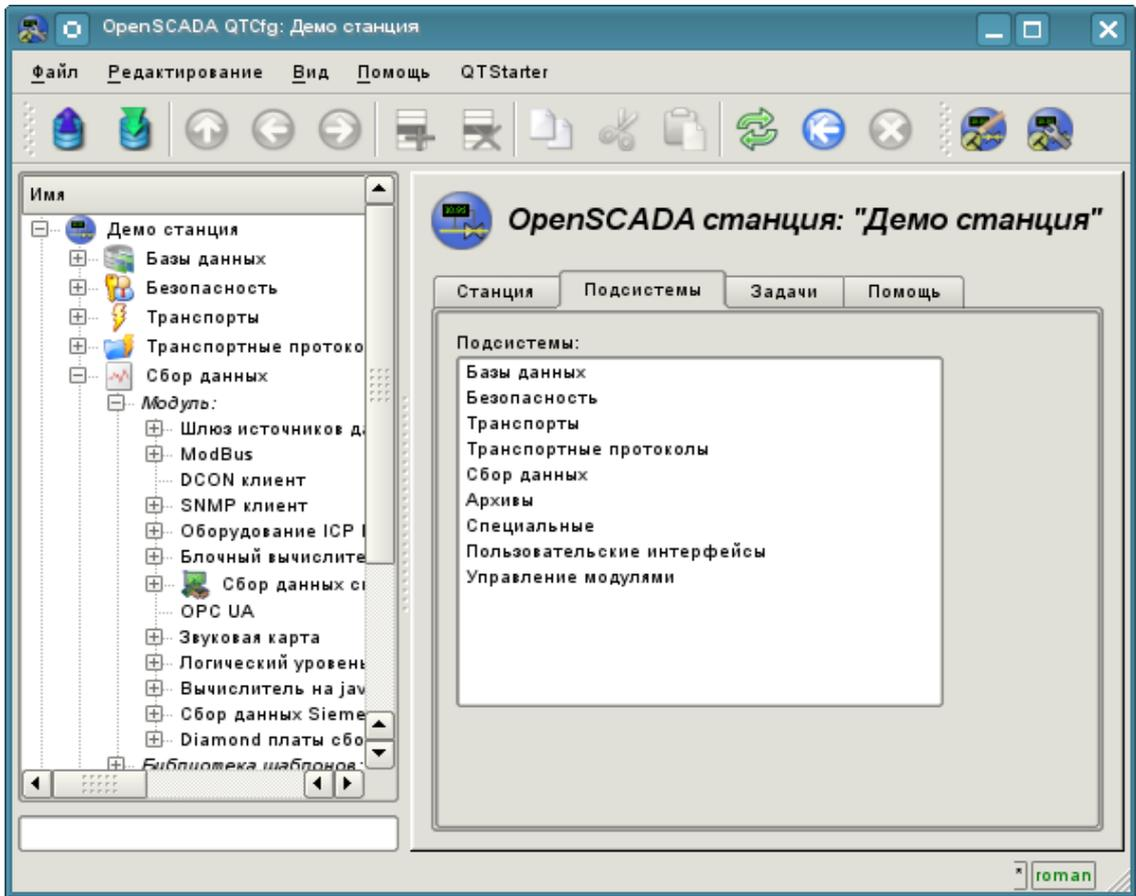
Рис. 4б. Вкладка "Подсистемы" корневой страницы конфигурации системы.
