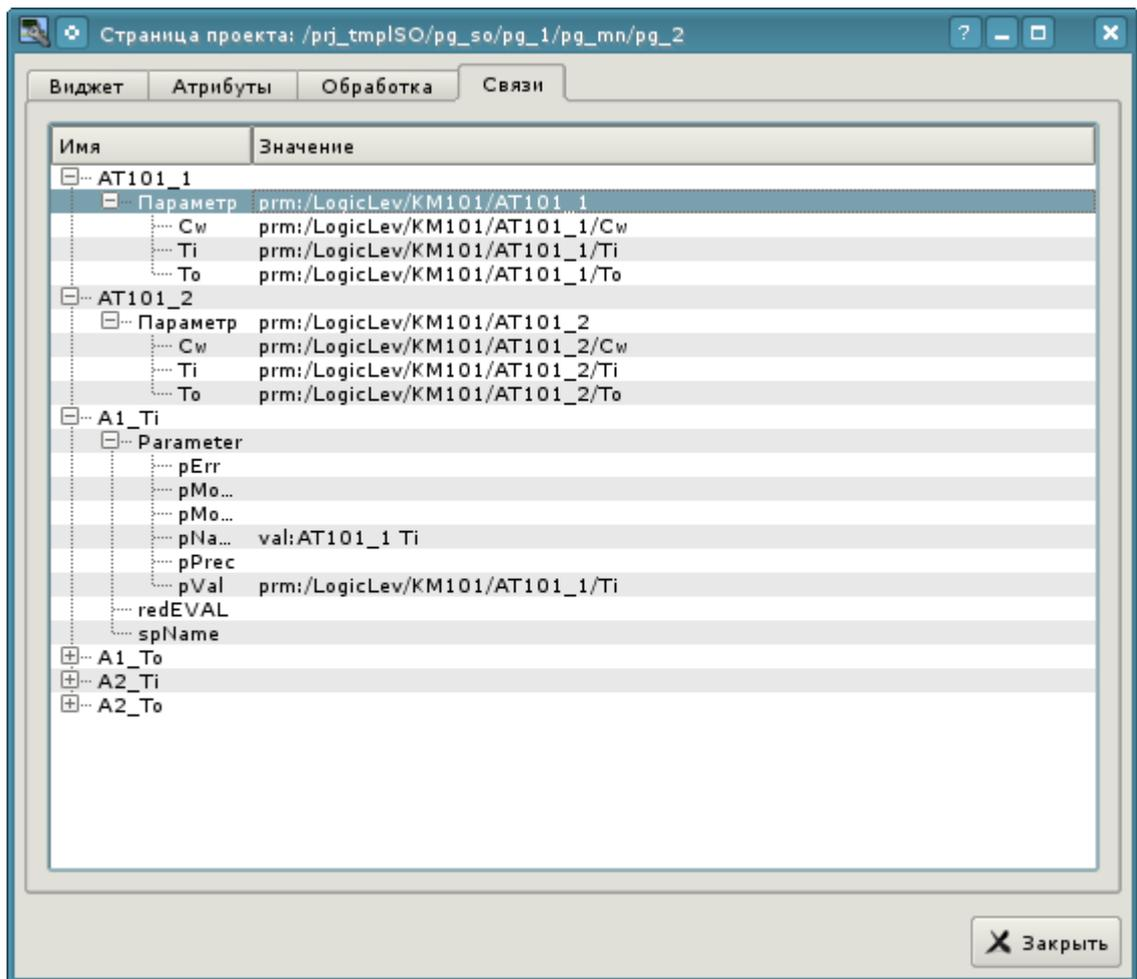
Рис. 5.3.3.2. Вкладка "Связи" диалога редактирования свойств мнемосхемы.
