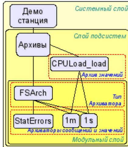
Рис. 4.6а. Иерархическая структура подсистемы "Архивы".
