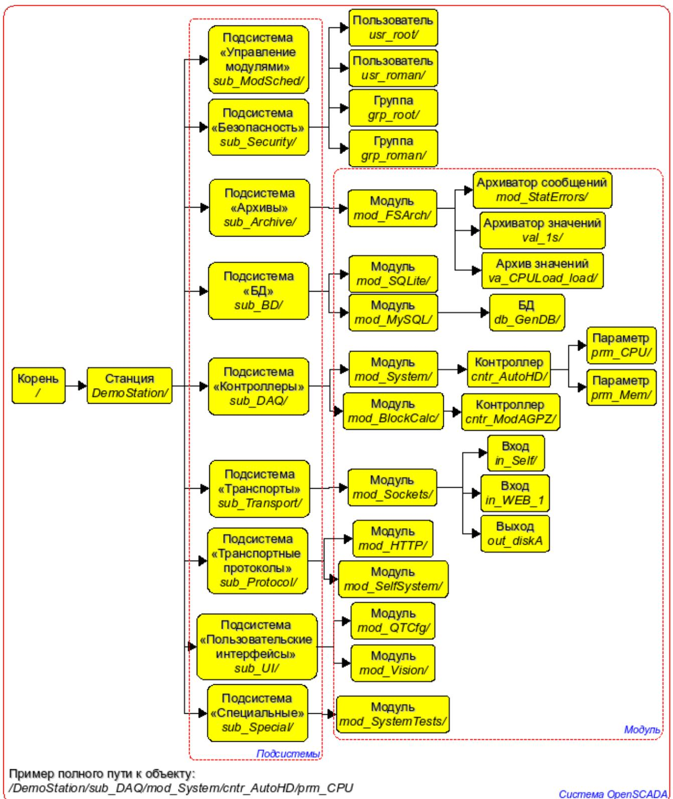
Рис. 8. Пример динамического дерева узлов системы OpenSCADA.
