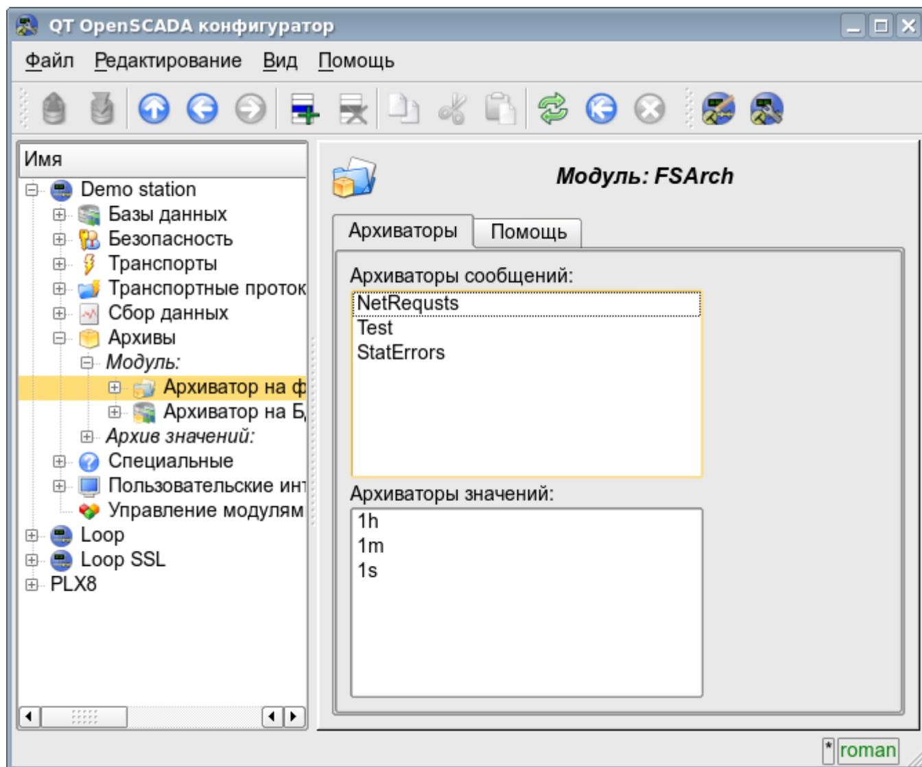
Рис. 4.6g. Вкладка "Архиваторы" модуля подсистемы "Архивы".
