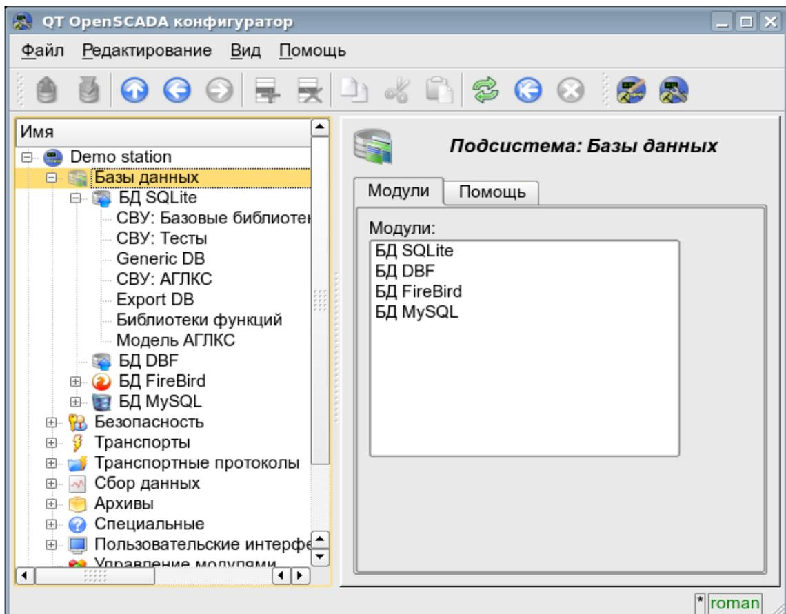
Рис. 4.1б. Вкладка "Модули" корневой страницы подсистемы "БД".
