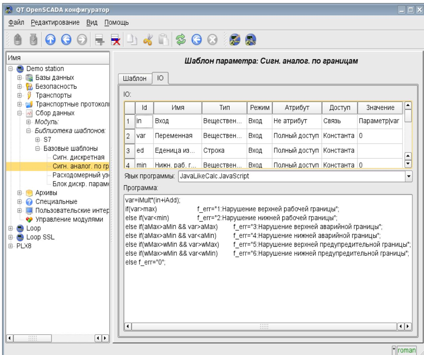
Рис. 9. Вкладка конфигурации шаблона параметров подсистемы "Сбор данных".
