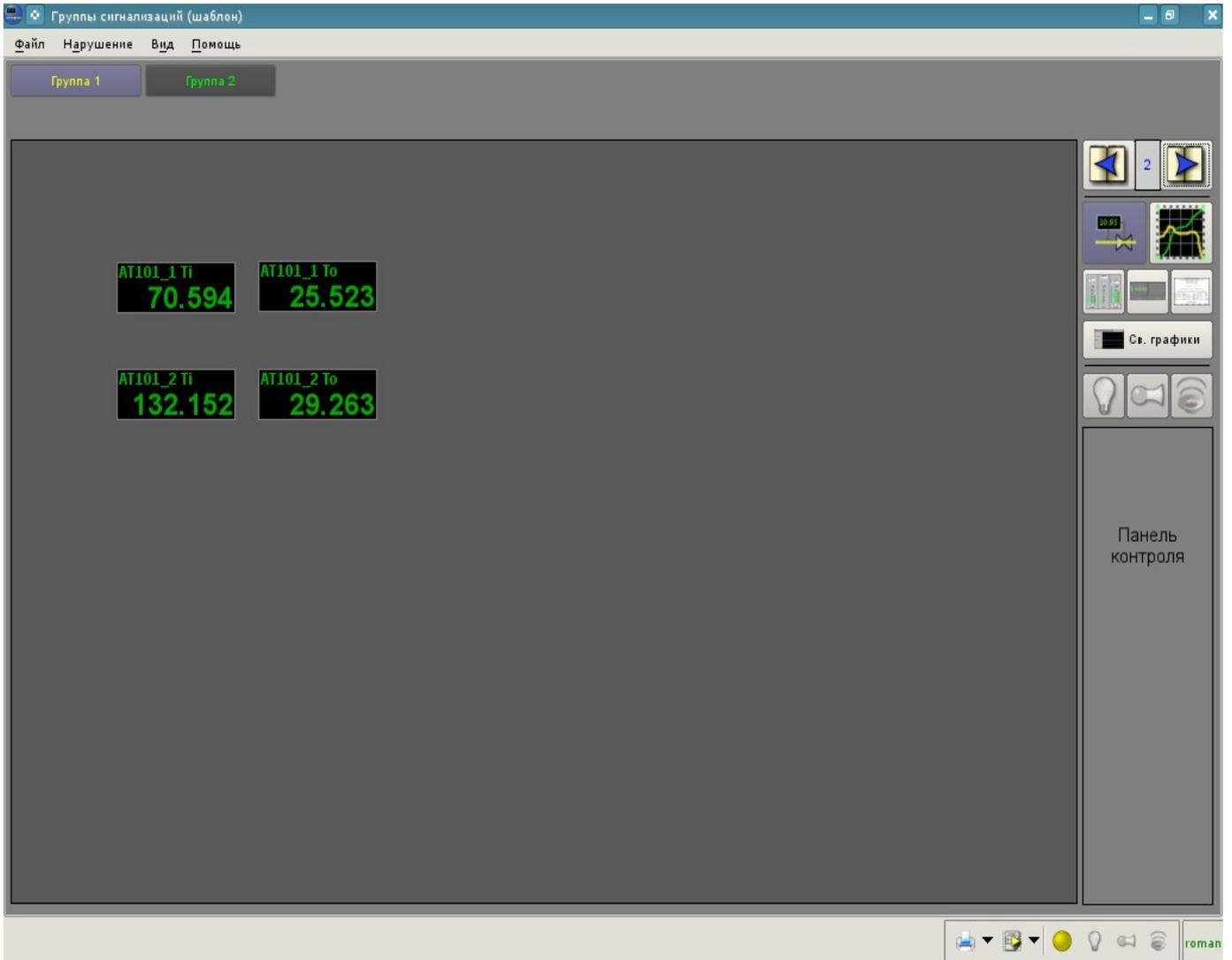
Рис. 5.2.6. Созданная мнемосхема с четырьмя подключенными сигналами.
