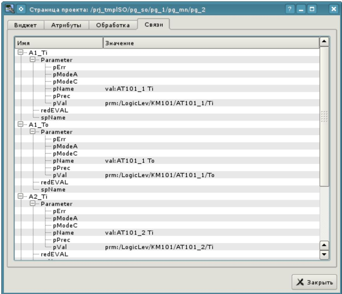
Рис. 5.2.5. Вкладка "Связи" диалога редактирования свойств мнемосхемы.
