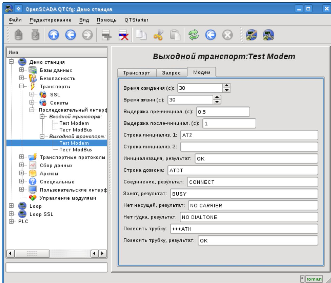
Рис.4. Вкладка "Модем" конфигурации модема исходящего последовательного интерфейса.
