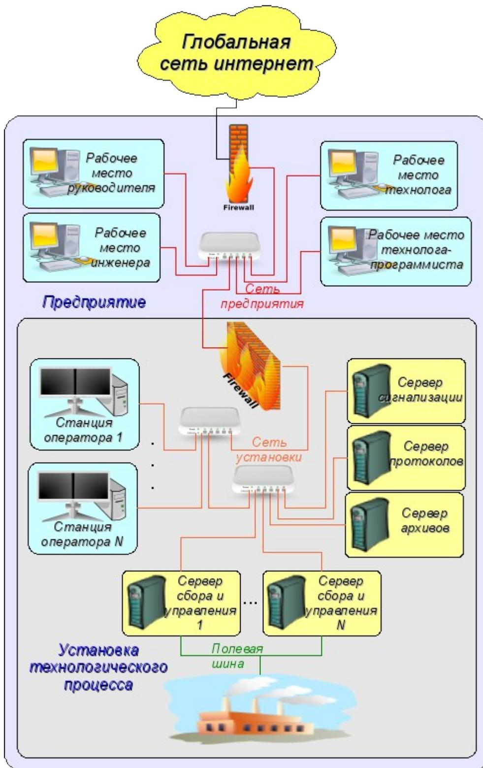
Рис. 2. SCADA-система.
