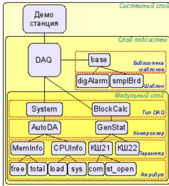
Рис. 4. Иерархическая структура подсистемы сбора данных.
