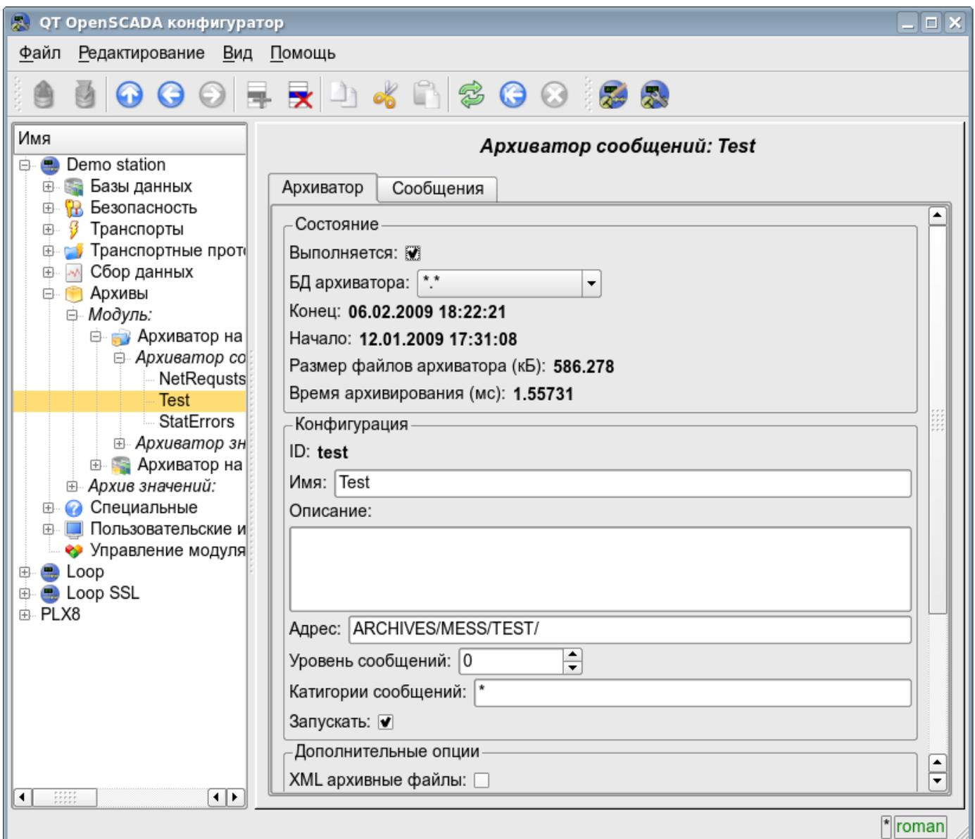
Рис. 4.6h. Главная вкладка конфигурации архиватора сообщений подсистемы "Архивы".
