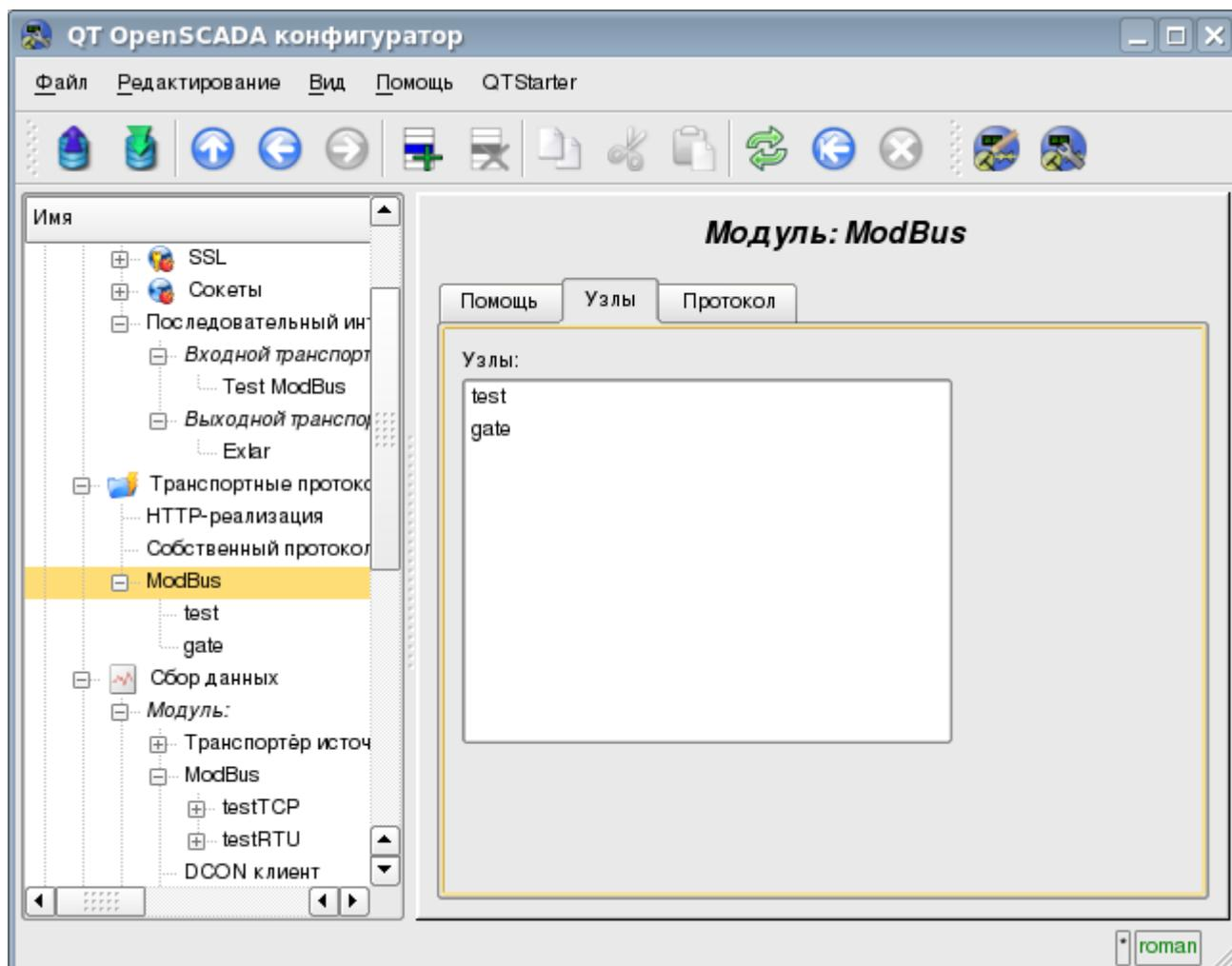
Рис.1. Вкладка перечня узлов обслуживания входящих запросов протокола.
