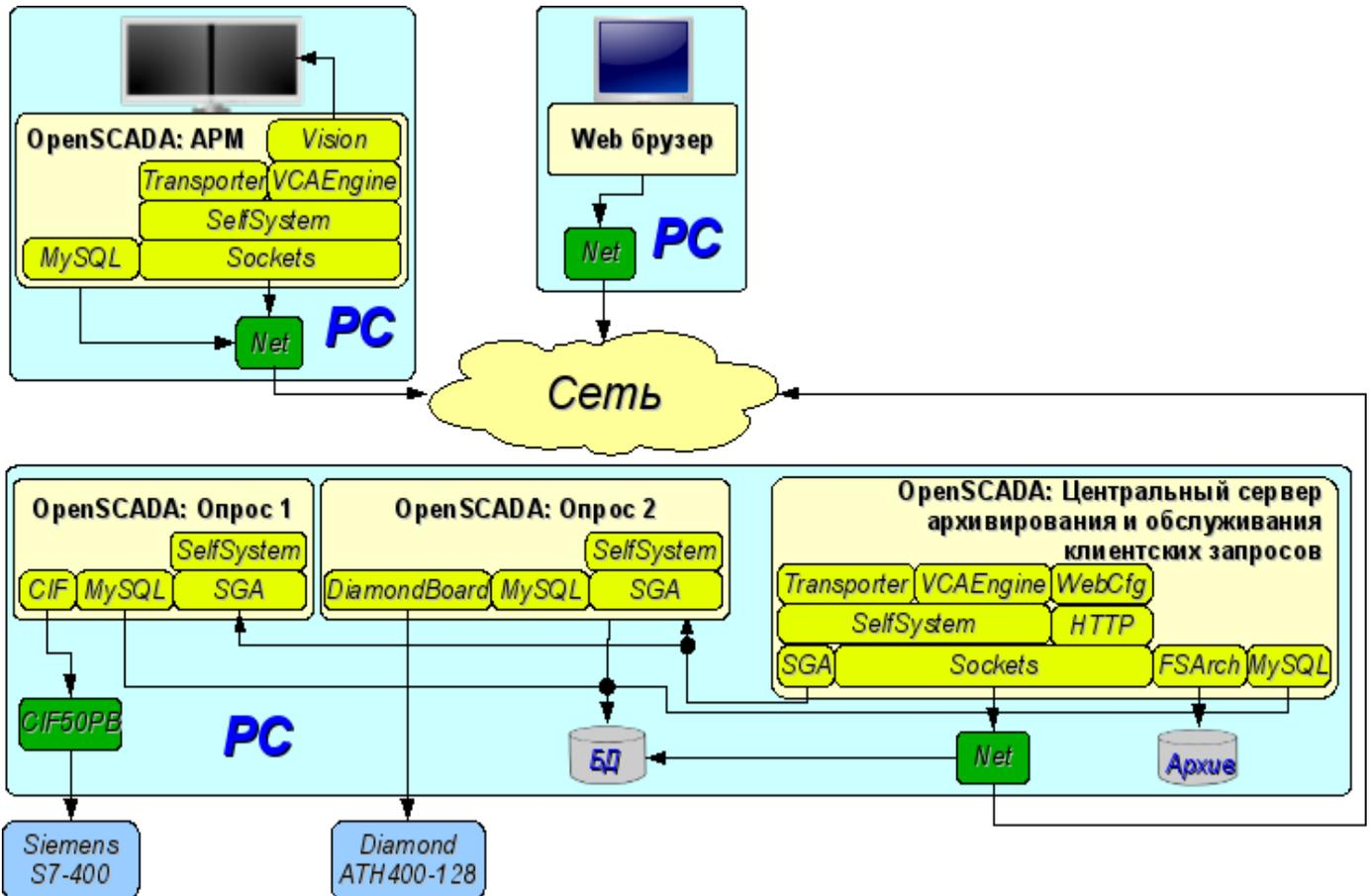
Рис. 3.8. Устойчивая, распределённая конфигурация
