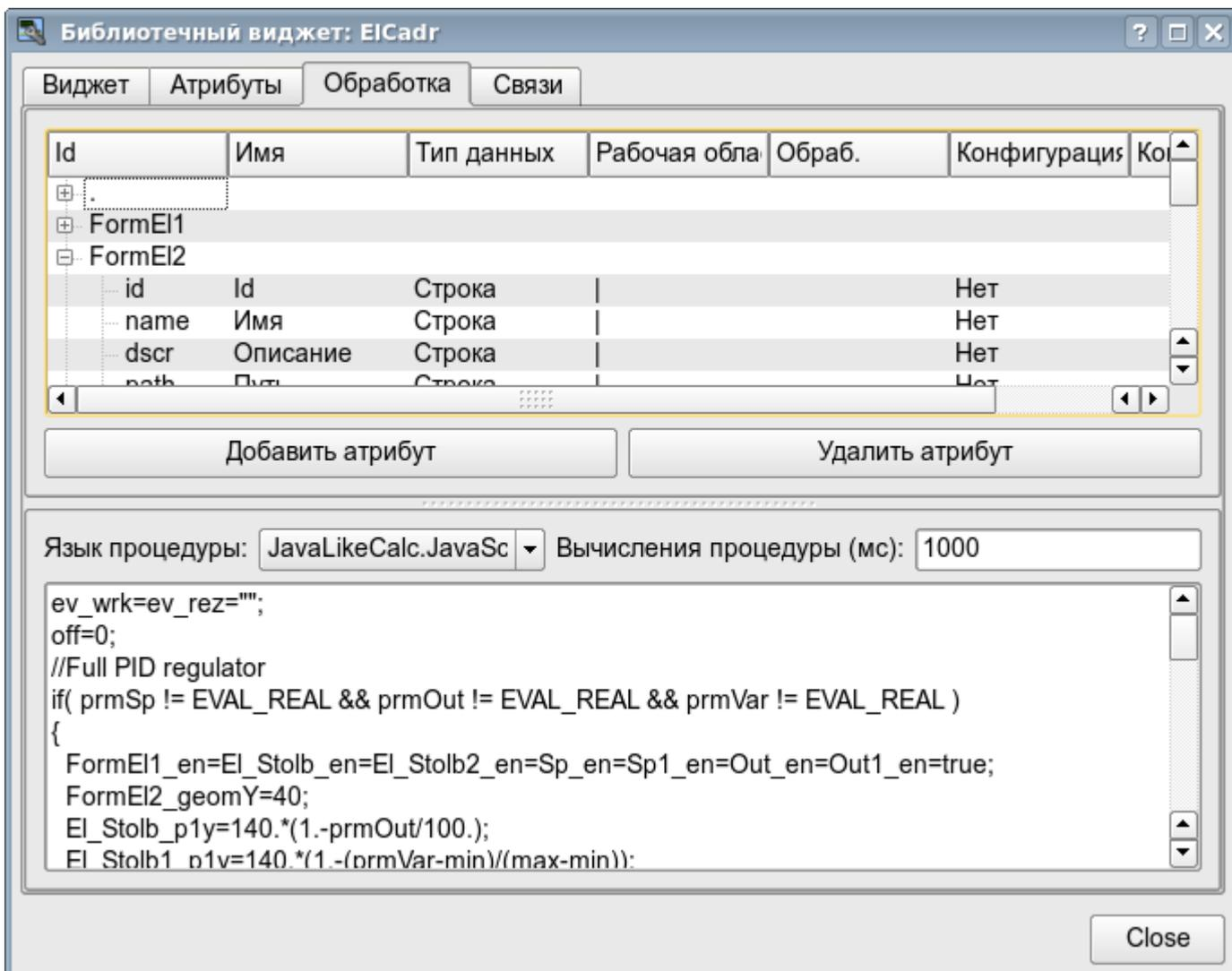
Рис.6. Вкладка обработки диалога редактирования свойств визуального элемента.
