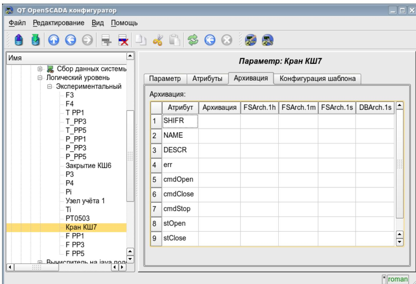
Рис. 4.5m. Вкладка "Архивация" параметра контроллера подсистемы "Сбор данных".
