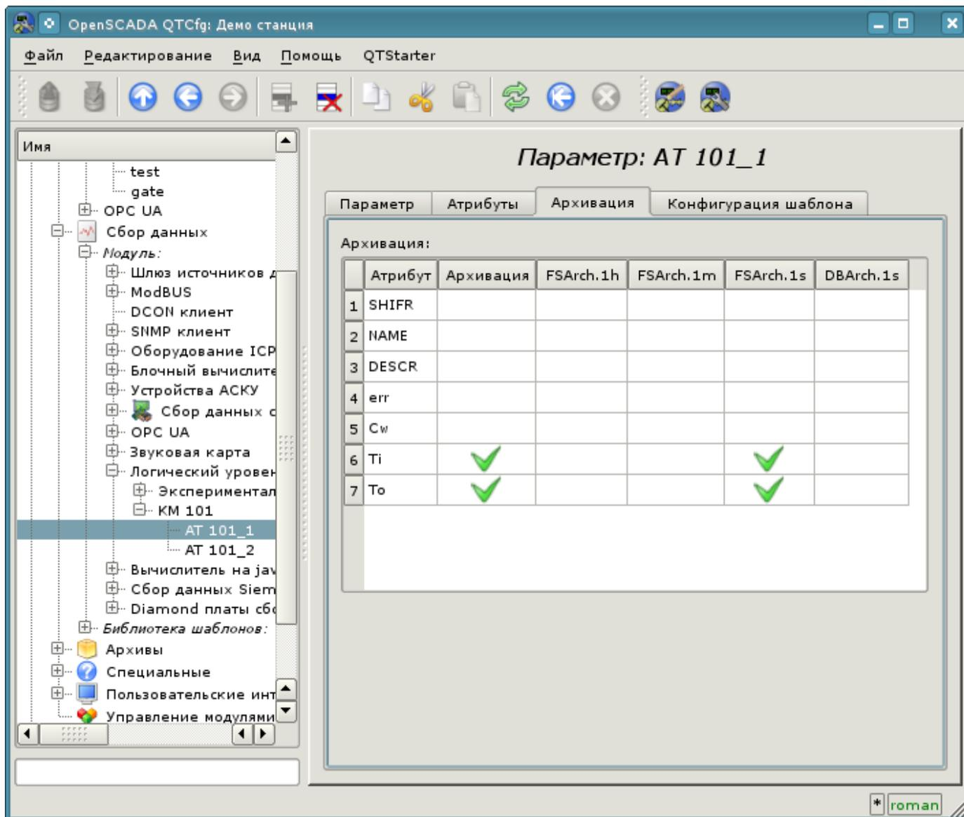
Рис. 4.3.1. Вкладка "Архивация" параметра AT101\_1 модуля "LogicLev".
