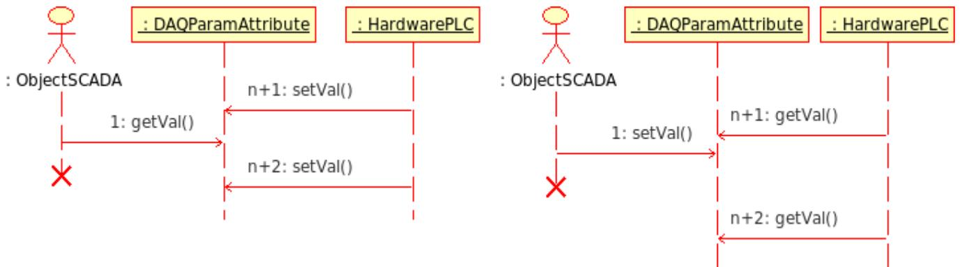
Рис. 5. Диаграмма последовательности взаимодействия при пассивном механизме работы.
