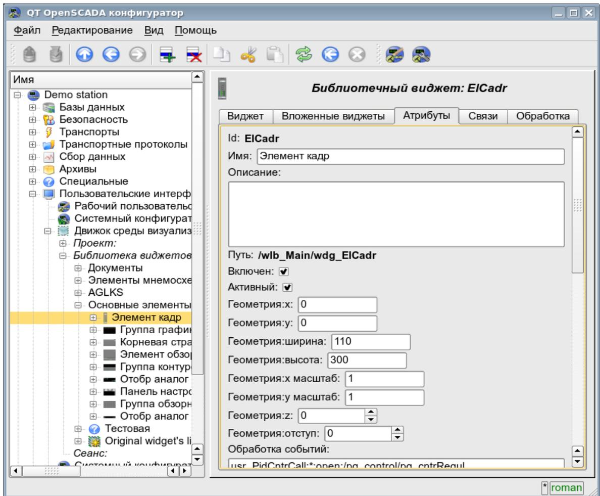
Рис.4.8 Вкладка атрибутов визуальных элементов.
