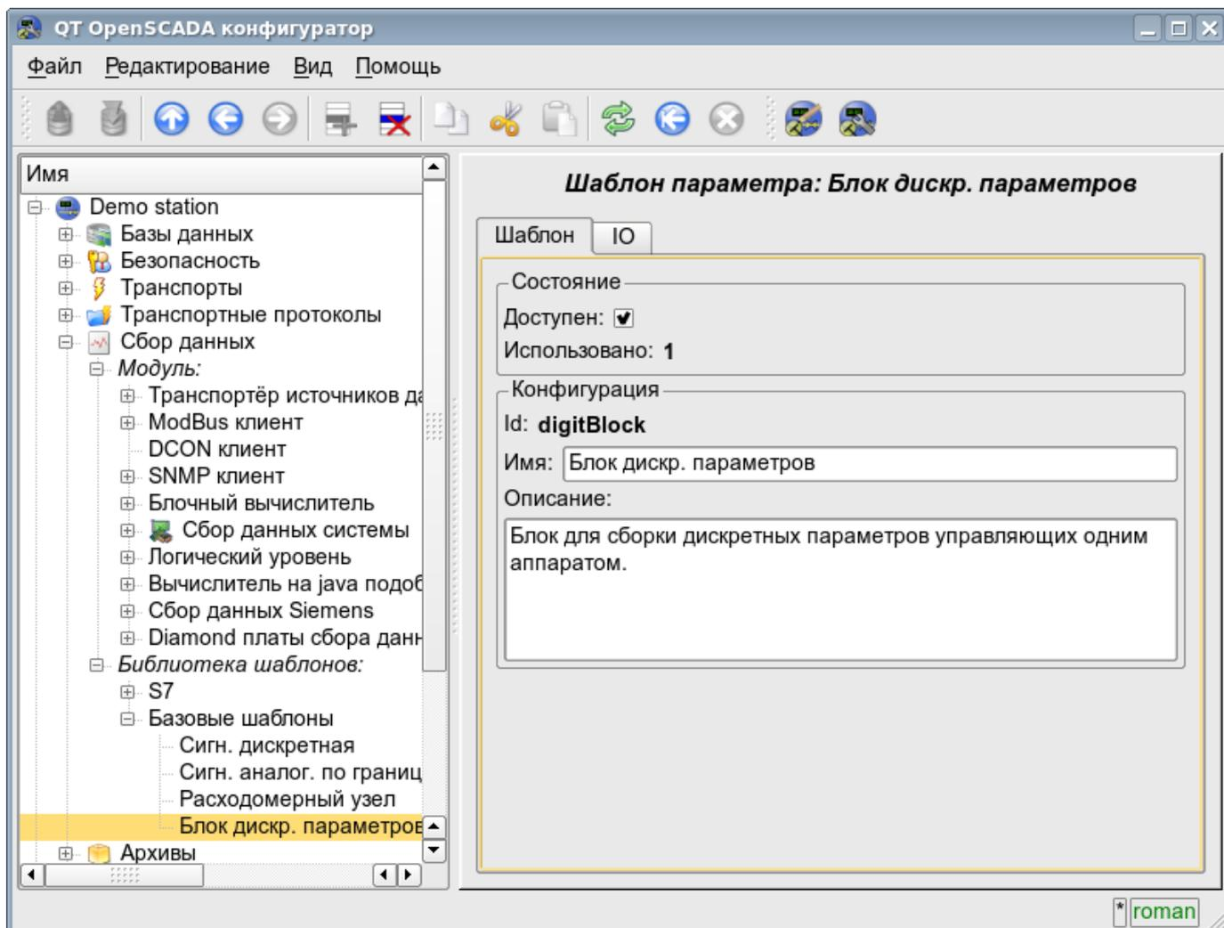
Рис. 4.5f. Главная вкладка конфигурации шаблона параметров подсистемы "Сбор данных".
