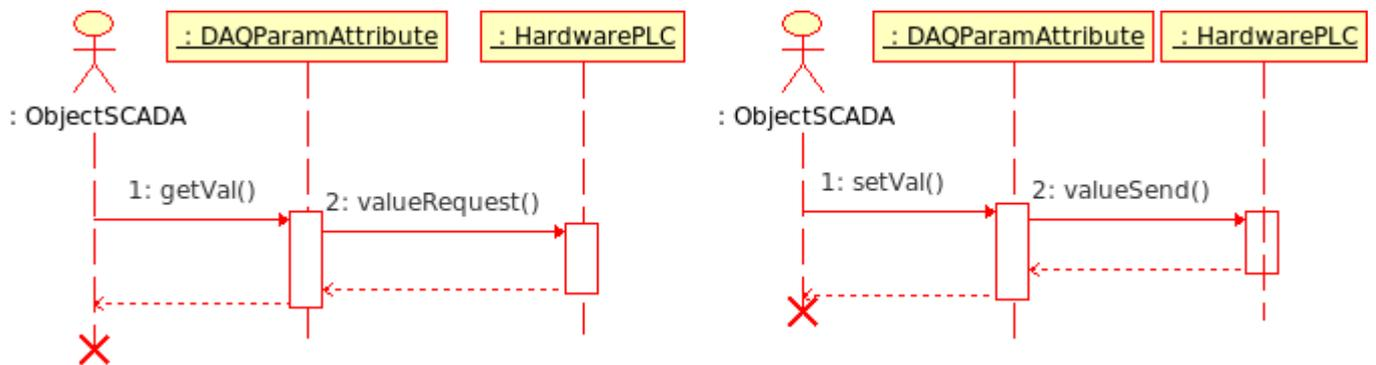
Рис. 2. Диаграмма последовательности взаимодействия при синхронных запросах.
