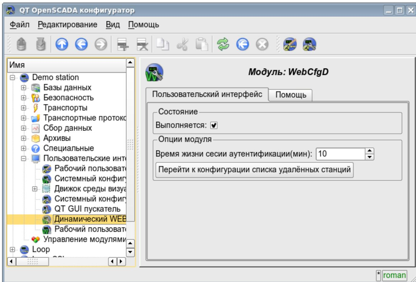
Рис. 4.7a. Вкладка "Пользовательский интерфейс" модуля подсистемы "Пользовательские интерфейсы".
