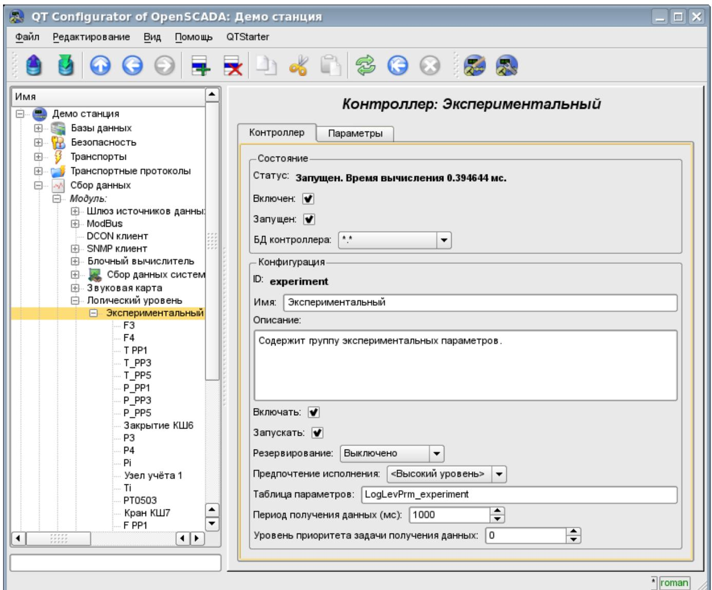
Рис. 4.5i. Главная вкладка конфигурации контроллера подсистемы "Сбор данных".
