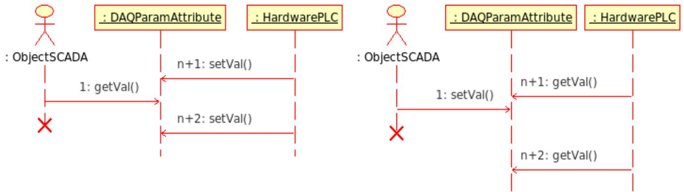
Рис. 5. Диаграмма последовательности взаимодействия при пассивном механизме работы.
