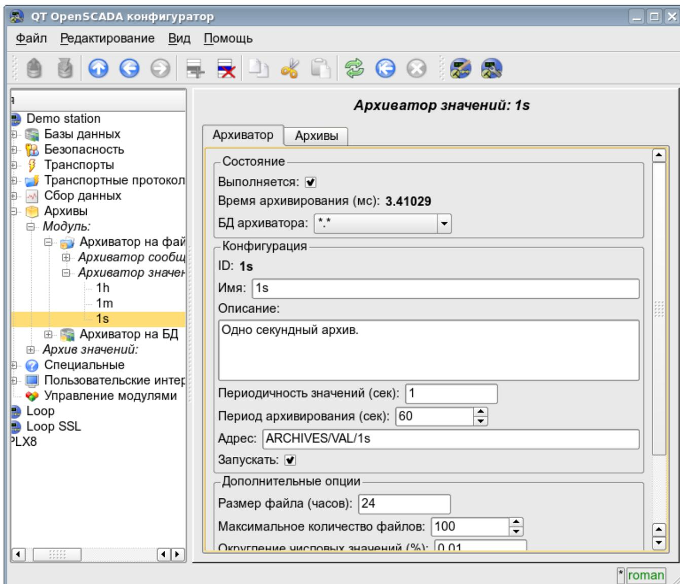
Рис. 4.6j. Главная вкладка конфигурации архиватора значений подсистемы "Архивы".
