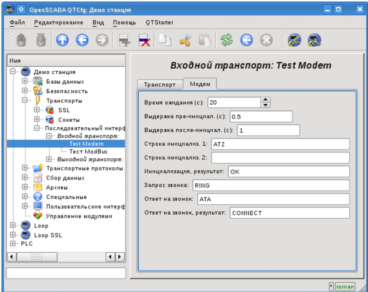
Рис.2. Вкладка "Модем" конфигурации модема входящего последовательного интерфейса.
