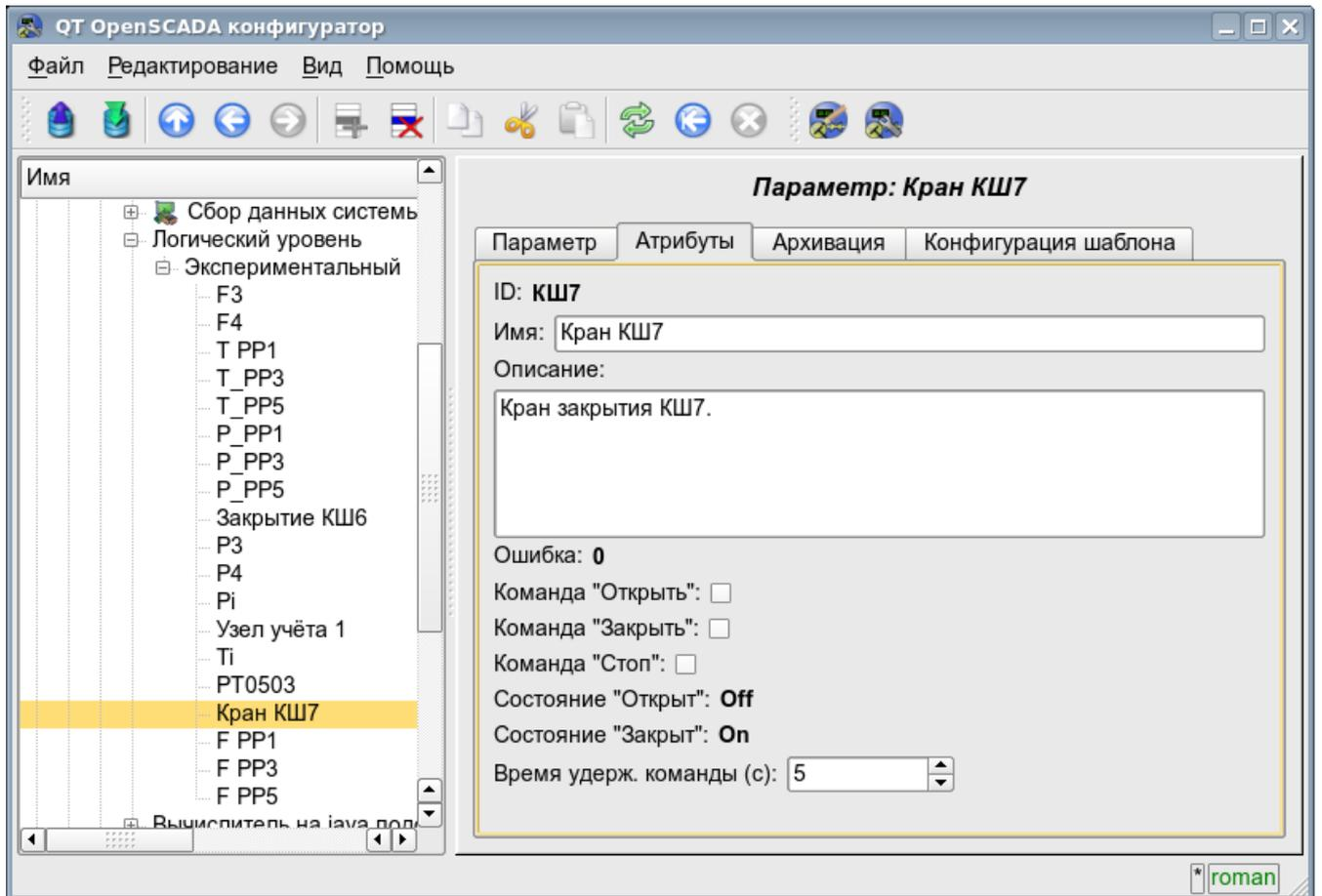
Рис. 4.5l. Вкладка "Атрибуты" параметра контроллера подсистемы "Сбор данных".
