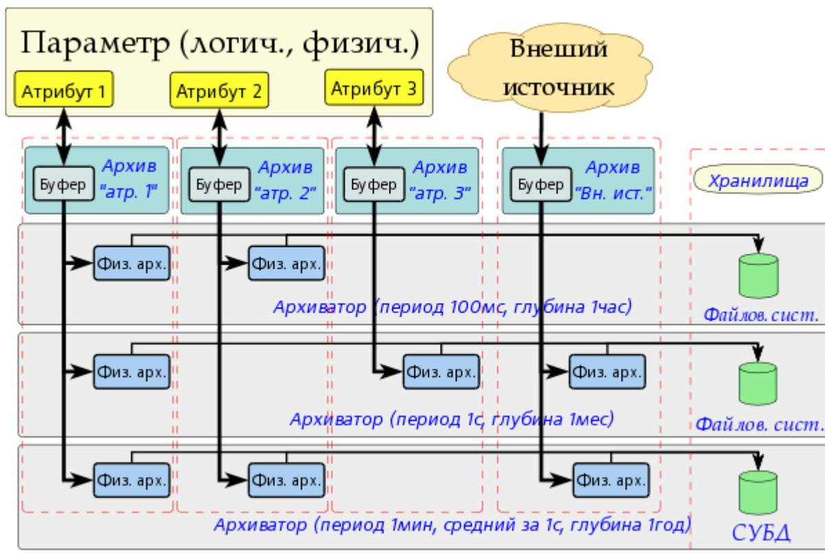
Рис.1. Общая схема процесса архивирования значений модуля FSArch.
