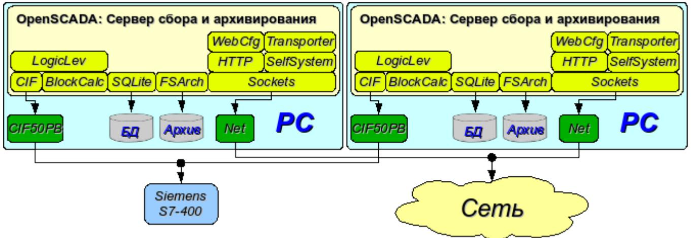
Рис. 3.2. Дублированное серверное подключение.
