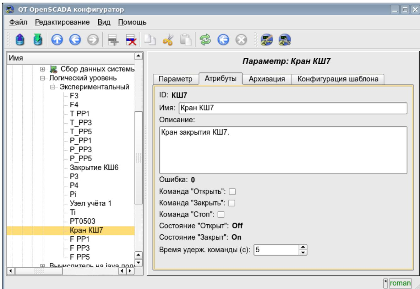
Рис. 4.5l. Вкладка "Атрибуты" параметра контроллера подсистемы "Сбор данных".
