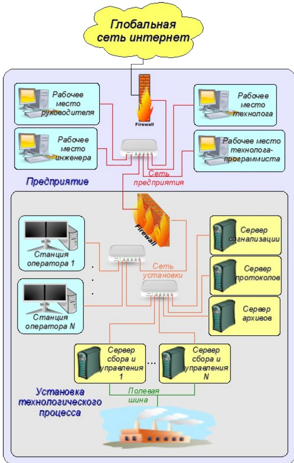
Рис. 2. SCADA-система.
