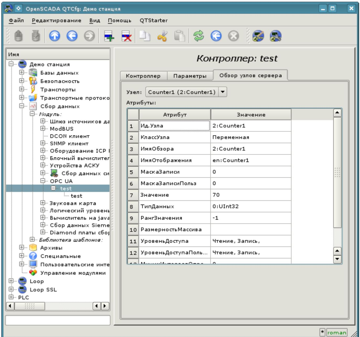
Рис.4. Вкладка "Обзор узлов сервера" страницы контроллера.
