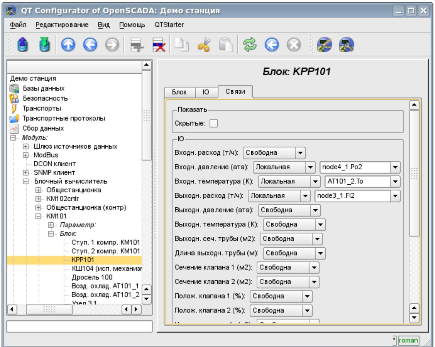
Рис. 5. Вкладка конфигурации связей блока блочной схемы.
