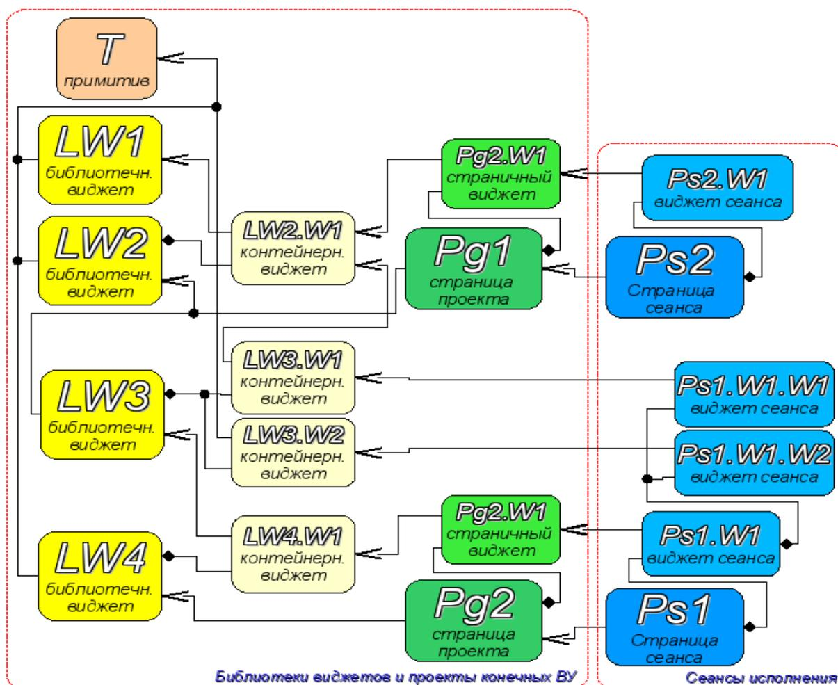
**Терминальный виджет** – Конечный элемент визуализации, или примитив. На стороне визуализации приобретает соответствующий визуальный образ.
