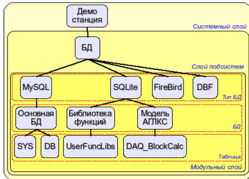
Рис. 4.1а. Иерархическая структура подсистемы "БД".
