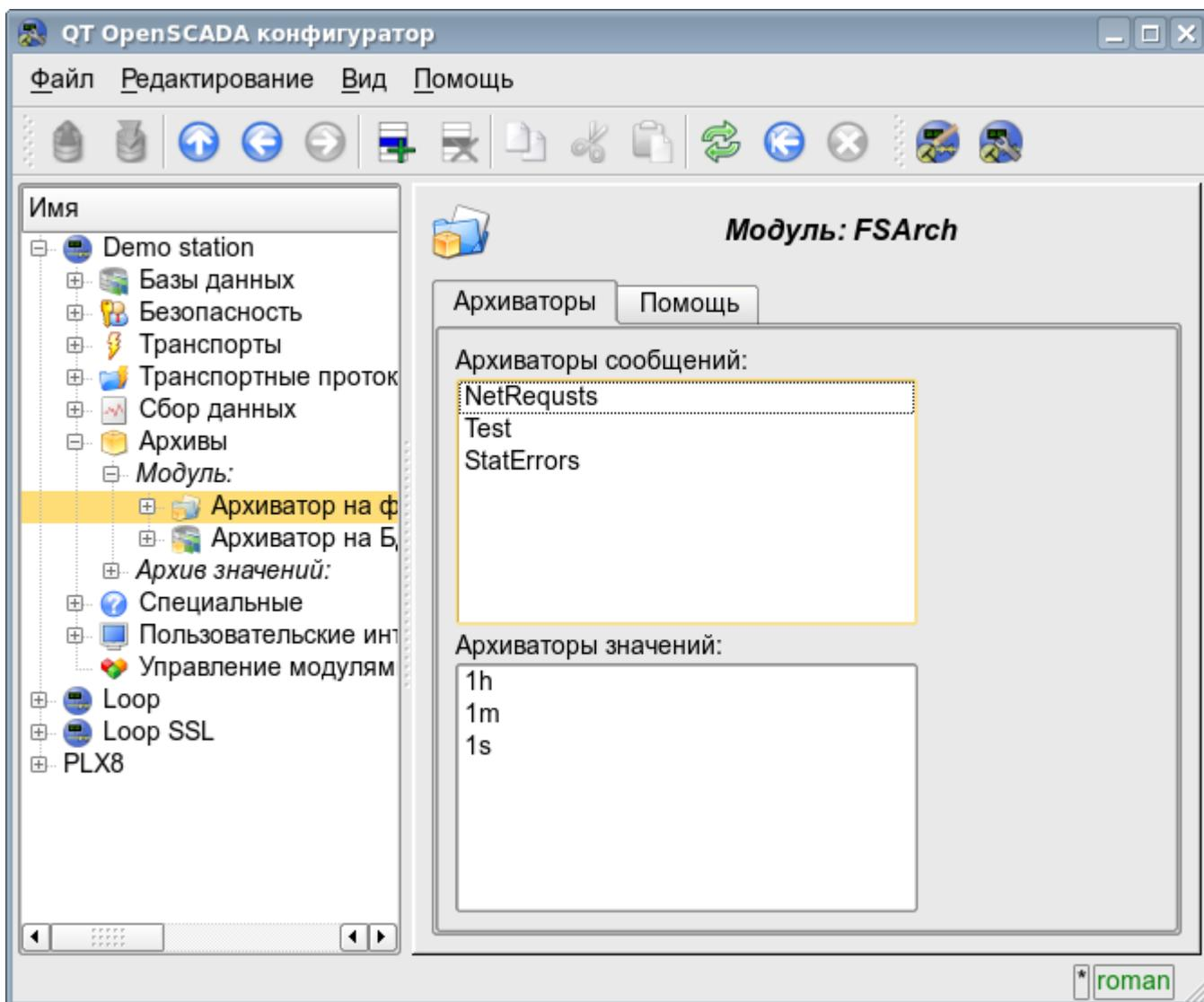
Рис. 4.6g. Вкладка "Архиваторы" модуля подсистемы "Архивы".
